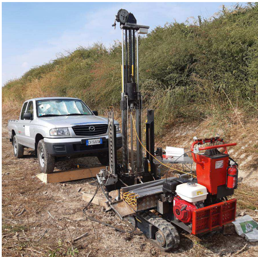
Figura 17 - Esecuzione prova SCPTU
