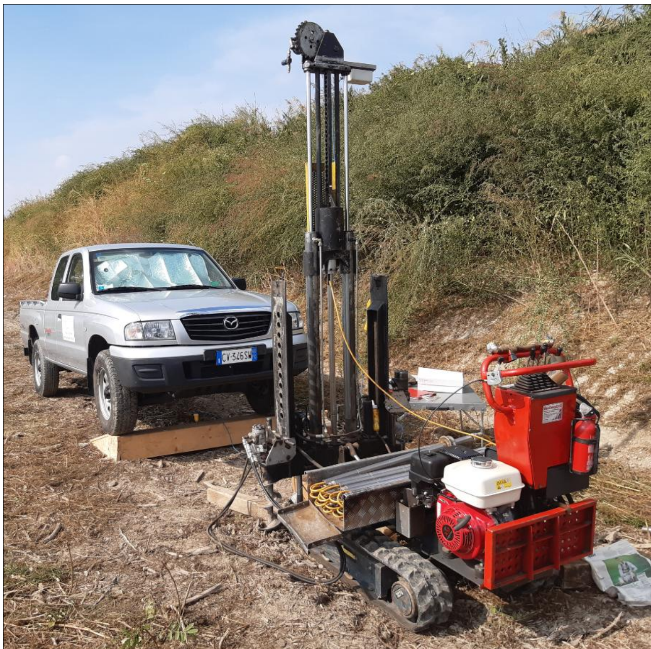
Esecuzione prova SCPTU
